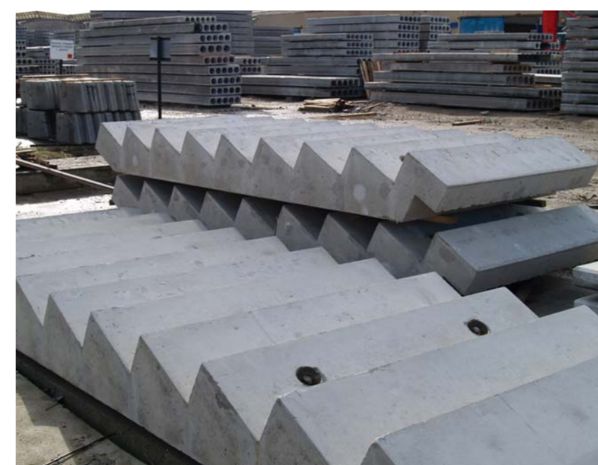
Schodiště na skládce
